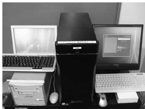
写真 5 両面共有型遠隔協調会議システム「Neue Luft」 メーカー：アイエスエム社製 OS：① Windows XP Professional SP2 ② Fedora Core 6
