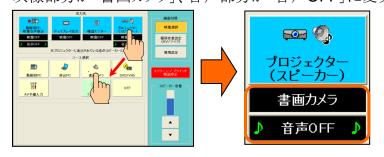
3) 次に、同じ出力先を選択後、映像ソースからCDを選択します。 映像部分は「書画カメラ」のまま、音声部分が「CD」に変わります。 ※3)→2)の操作も可能です
