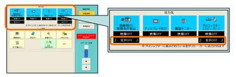
2)まず、プロジェクターまたは教師用PC映像音声取込を選択し、映像ソースから書画カメラを選択します。 映像部分が「書画カメラ」、音声部分が「音声OFF」に変更されます。
