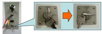
2)システム電源が起動し、起動処理が始まります。 タッチパネルに画面が表示され、操作できるまで1分程度かかります。
