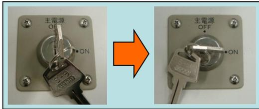
2) システム電源が起動し、起動処理が始まります。
