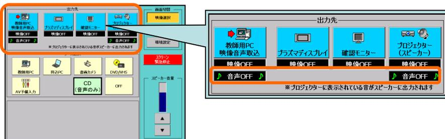
2) まず、プロジェクターまたは教師用PC映像音声取込を選択し、映像ソースから書画カメラを選択します。映像部分が「書画カメラ」、音声部分が「音声OFF」に変更されます。
